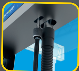
Tuyau vapeur et aspiration
